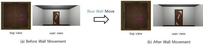
**그림 2:** 실험 도중 파란색 선에 위치한 벽이 움직이는 예시. (a)는 벽이 움직이기 전의 모습이고 (b)는 벽이 사용자를 향해 움직인 후의 모습을 나타냄.
