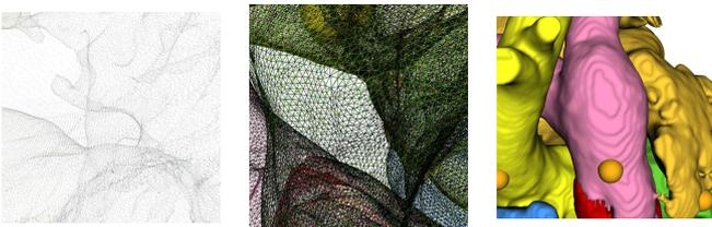
그림 4. 표면 시각화: a) point cloud, b) wire frame c) surface
