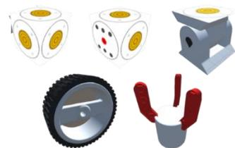
**Figure 2** 사용된 모듈의 형태: 기본(Base), 모터(Motor), 피벗(Pivot), 바퀴(Wheel), 그래버(Grabber) 모듈.
